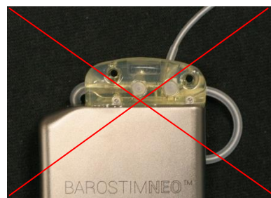
Colocação incorreta do elétrodo atrás do IPG
