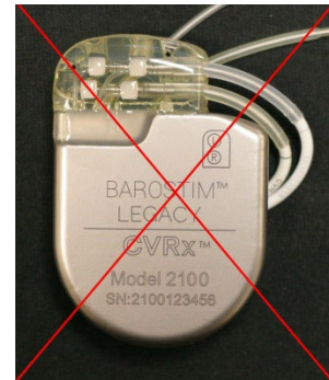
Incorrecte plaatsing van lead achter IPG
